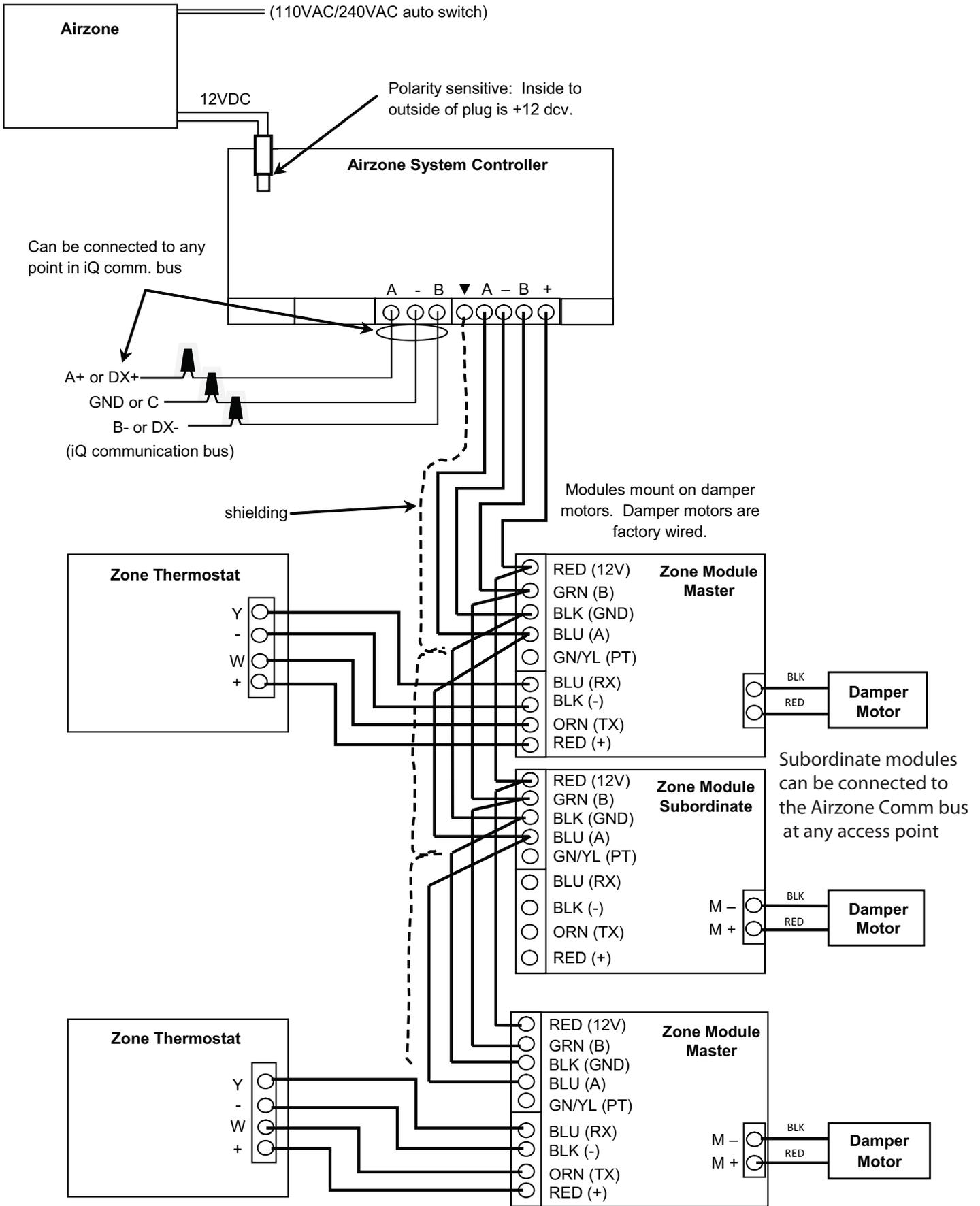
Figure 28. iQ Zone Control Wiring
