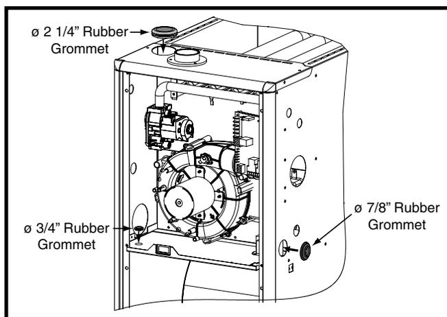
Figure 28. Rubber Grommets
